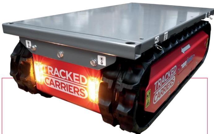
La serie 700 di Tracked Carriers è incredibilmente copatta, e consente l'accesso ai siti più limitati. Anche se hanno accessi di solo 600 mm. I modelli 700 R e 700 PRO, hanno una capacità di carico di 700 kg e tutte le caratteristiche dei modelli più grandi.
