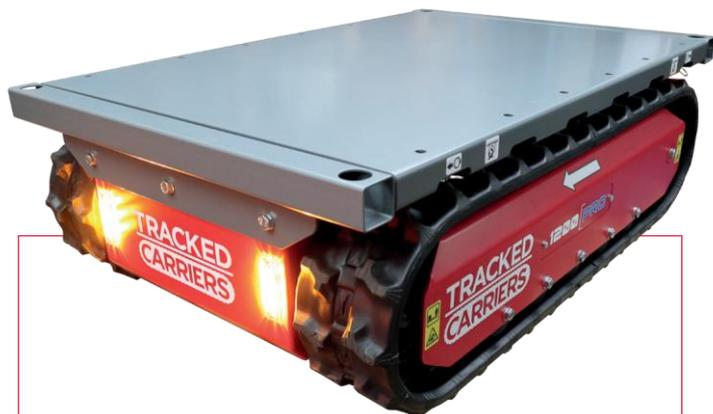
La serie 1200 R e PRO, sono I carri cingolati a tutto tondo. Con una larghezza di soli 750 mm, sono in grado di passare attraverso la maggior parte delle porte e con un carico Massimo di 1200 kg. Gli usi sono infiniti.
