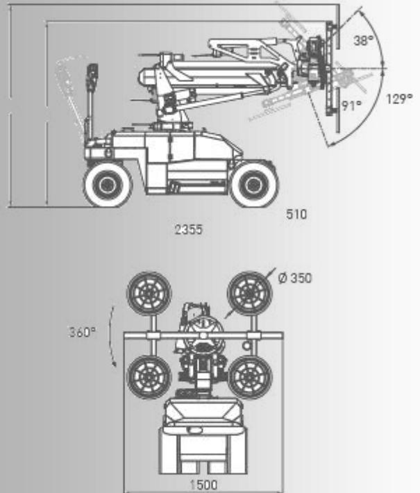
Il Robot, **ORION L6** è una gru semovente su ruote, dotata di manipolatore e alimentata con un motore elettrico a batteria.
